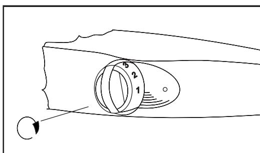
**ⓘ** При установке термостата в положение „6” (на максимум) в случае увеличения нагрузки на прибор, например, во время жары - компрессор может работать постоянно. Это не вызовет никакого сбоя в работе прибора.
